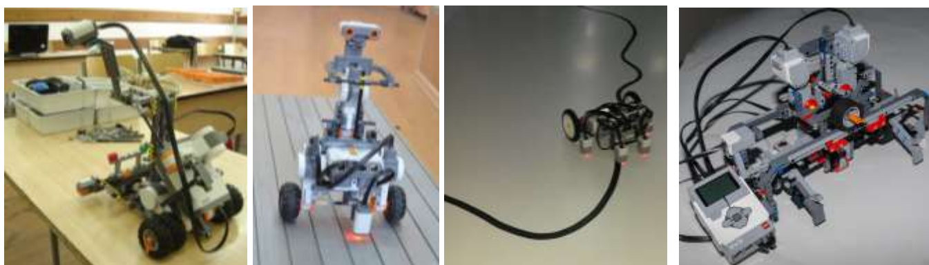
2. ábra a). A robot építése b). Egyensúlyozó robot c). Vonalkövető d). Nyomtató
