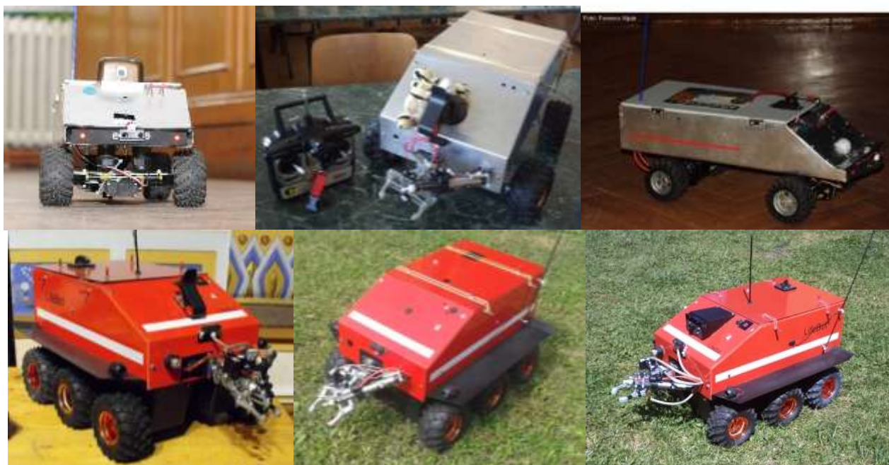
8. ábra Tűzoltó- (a-felső panel) és életmentő (b-alsó panel) robotok (fotó: Harkó Cs. és Krecht R.)
