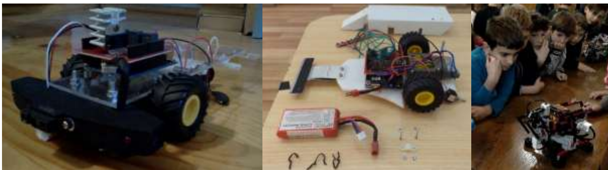
7. ábra Egyszerű eszközöktől a bonyolultig: Akadálykerülő, nyomkövető és Rubik-kocka kirakó robot
