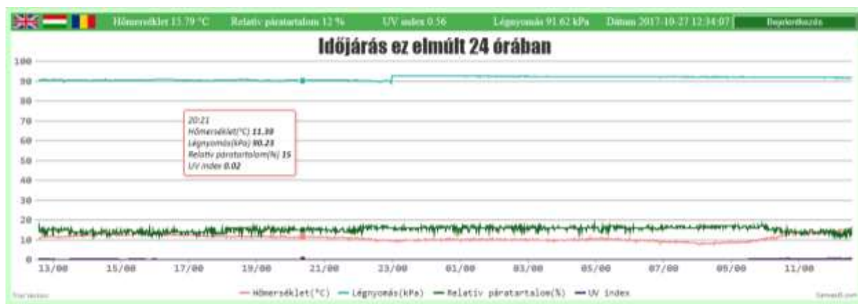
19. ábra Az időjárás-állomás mérési adatai a http://cansat1.netai.net/ lapon (Medgyesi A. XI.A)
