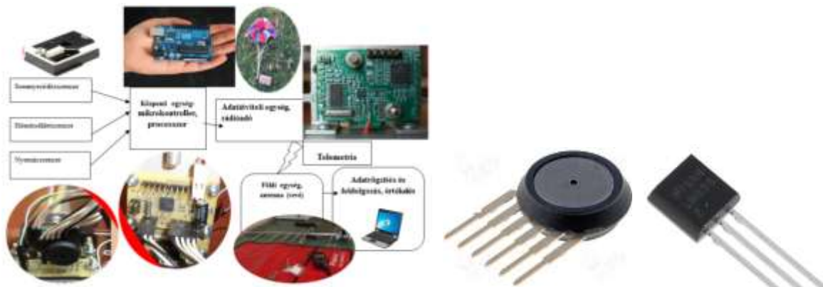
10. ábra A mérőegység (CanSat2012) elvi vázlata és szerkezeti elemei; MPX4115A- szilícium vékonyréteg piezorezisztív nyomásszenzor és altiméter. LM335- integrált hőmérsékletszenzor
