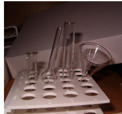
kémcsőállványon balról jobbra: peremes kémcső, lyukacsos gömblombik, kémcső, tölcser
