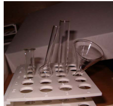
kémcsőállványon balról jobbra: peremes kémcső, lyukacsos gömblombik, kémcső, tölcsér
