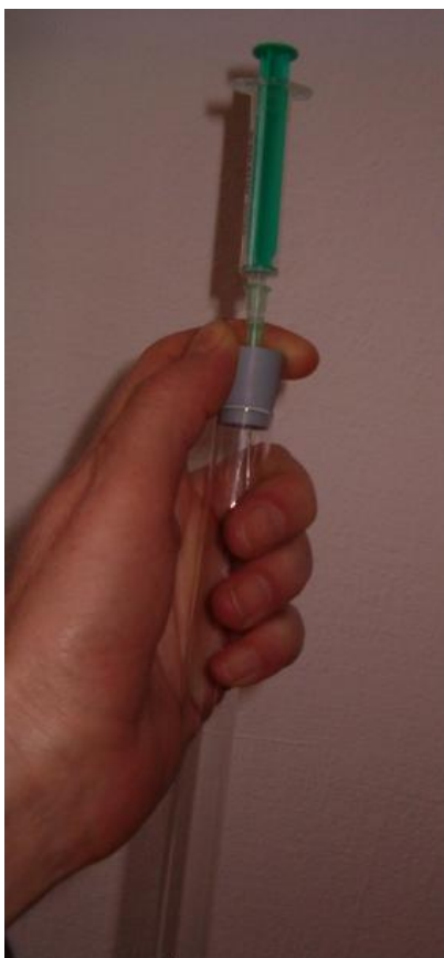
A normál (nagyméretű) kémcsőbe illesztett gumidugó, benne injekciós tű, fecskendővel. A lényeg: ujjaiddal jól szorítsd a kísérlet alatt, nehogy kirepüljön!
